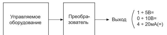
● Данное изделие имеет встроенный режим преобразователя. Следует выбрать A -- 1 ( $0 \div 10\text{V}$ ) или A -- 1 ( $1 \div 5\text{V}$ ) или A -- 3 ( $4 \div 20\text{mA}$ ) в режиме выбора входа во второй группе установок.
