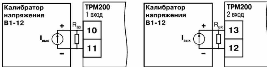
Рисунок Ж.3 ( R_{вх} = 100 \text{ Ом} \pm 0,1\% )
