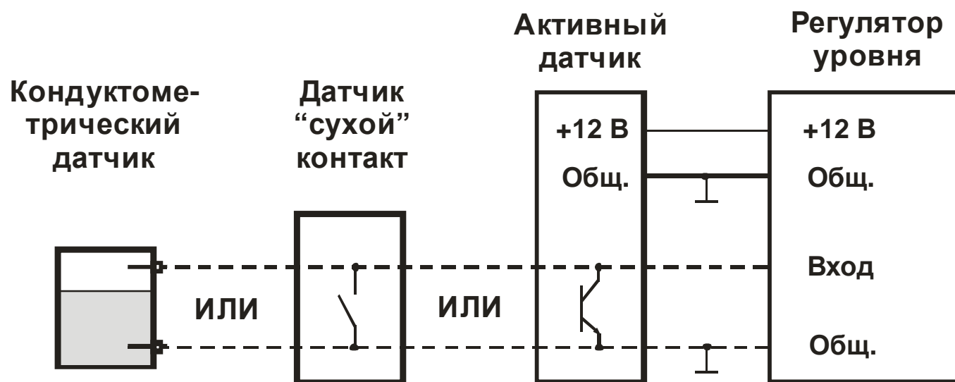
Рисунок 3.2 – Общая схема подключения входных датчиков к прибору
