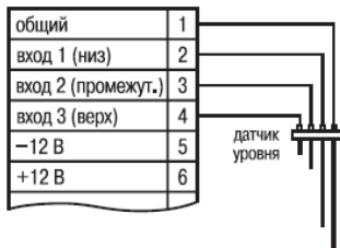
Рис. Б2. Схема подключения кондуктометрических датчиков уровня
