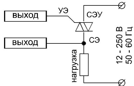
Рис.2. Схема подключения симисторов TC122-25, TC142-80.
