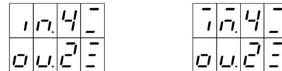
Для дискретных входов "in 1" ... "in C", выходов сумматоров "СУ 1" ... "СУ 4" и выходов "ou 1" ... "ou C" в правом разряде отображаются допустимые действия данного управляющего сигнала над выходами или признак блокирующего входа (только для "in 1" ... "in C"):
