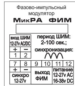
Схема блокочения на  $\mu$ PA -  $\phi M$
