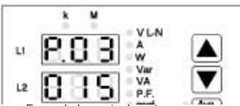
Esempio impostazione tempo integrazione potenza a 15 min. Example of power integration time set to 15 min.
