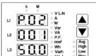
Esempio impostazione rapporto TV a 150 (15000 / 100). Example of VT ratio set to 150 (15000 / 100).
