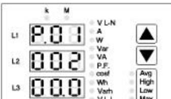
Esempio impostazione rapporto TA a 200 ( 1000 / 5). Example of CT ratio set to 200 ( 1000 / 5).
