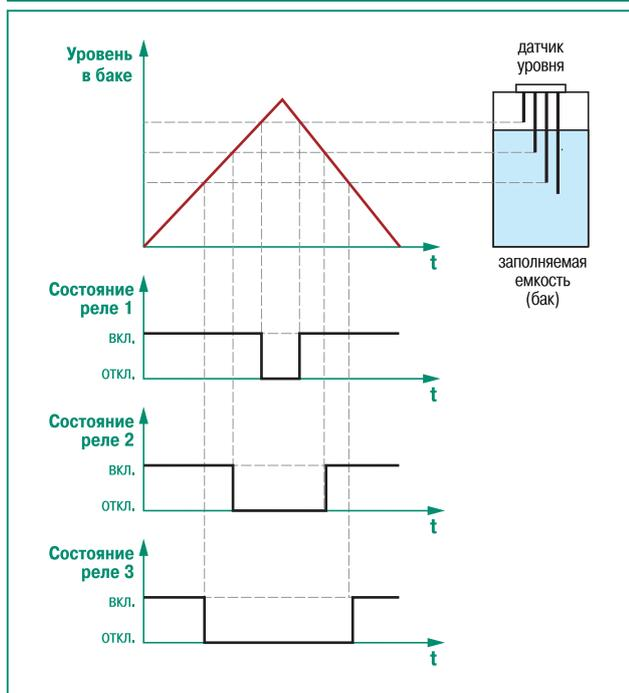
**Режим работы реле** в любом из каналов может быть изменен пользователем при помощи соответствующего коммутатора. При соприкосновении электрода датчика с жидкостью выходное реле в зависимости от положения его коммутатора может переводиться в состояние «**выключено**» (см. рис.) или, наоборот, в состояние «**включено**».
