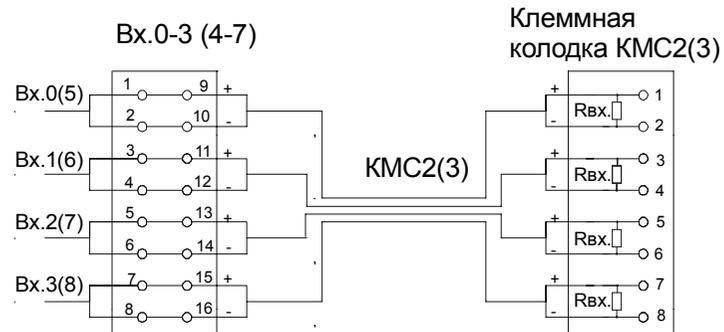
Модуль аналого-цифрового преобразования
