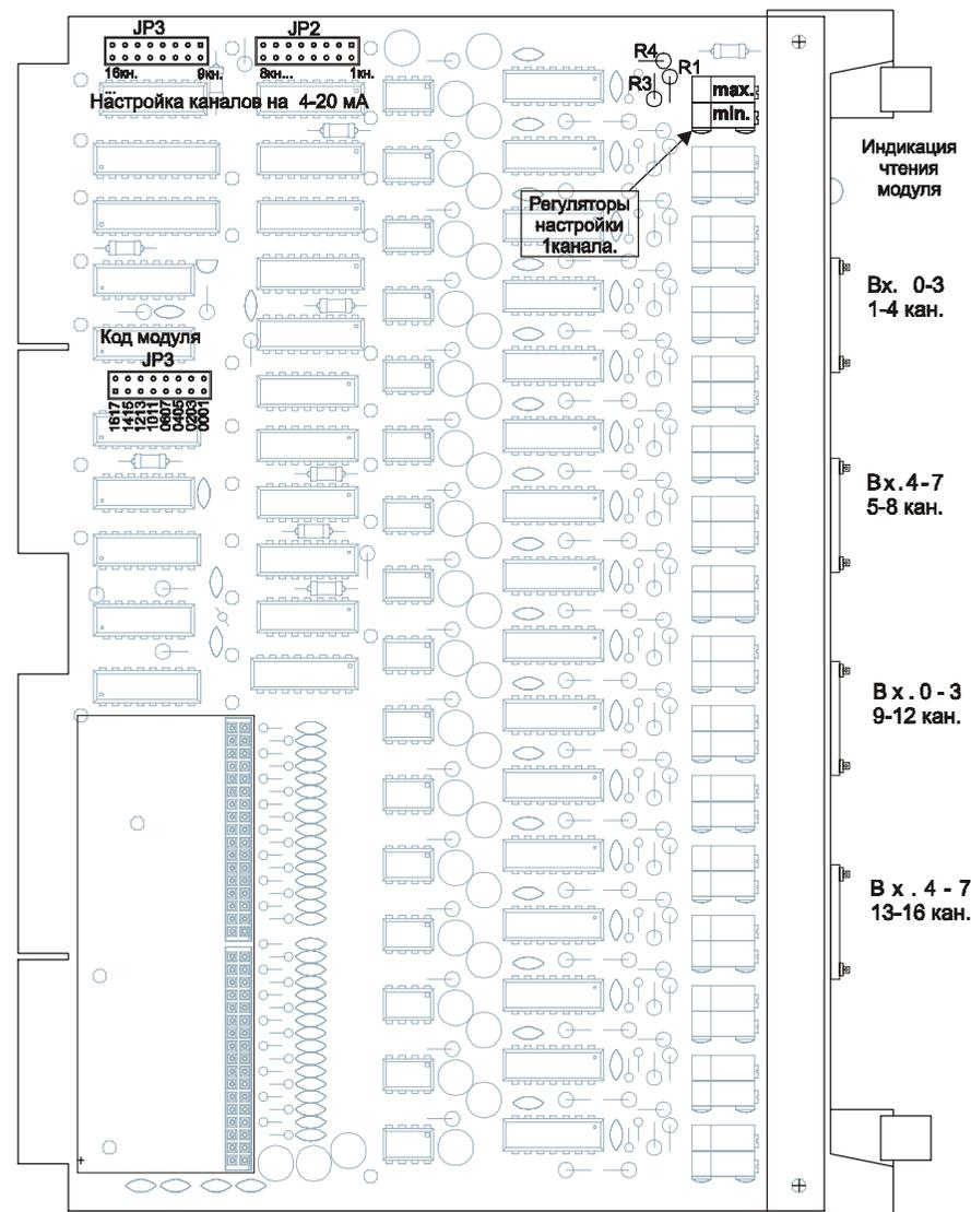
Схема внешних соединений модуля АЦП16
