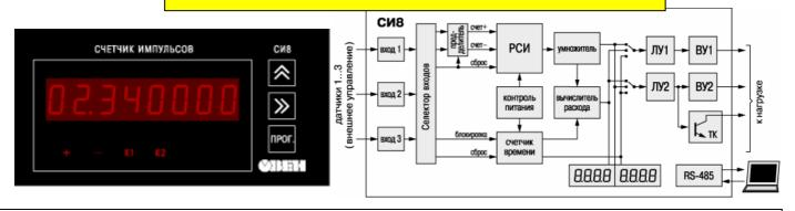
Микропроцессорный **счетчик импульсов СИ8** Используется для подсчета количества продукции на транспортере, длины наматываемого кабеля или экструзионной пленки, сортировки продукции, отсчета партий продукции, суммарного количества изделий и т.п.
