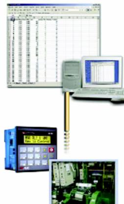
Данная мощная программная утилита осуществляет сбор данных приложения ПЛК, а затем экспорт данных в Excel-файлы для последующей обработки. Экспорт данные производится в соответствии с определяемым пользователем списком.
